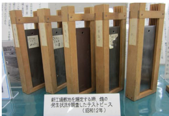
敷地調査に使用したテストピース
