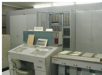
池田記念室 世界最古級の稼動する コンピュータFACOM128B
