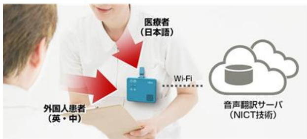
図2 ウェアラブル型ハンズフリー音声翻訳端末の利用イメージと指向性の関係
